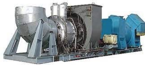
Figur 9. UGT2500 gasturbin från Zorya Mashproekt (2,5 MWe).
