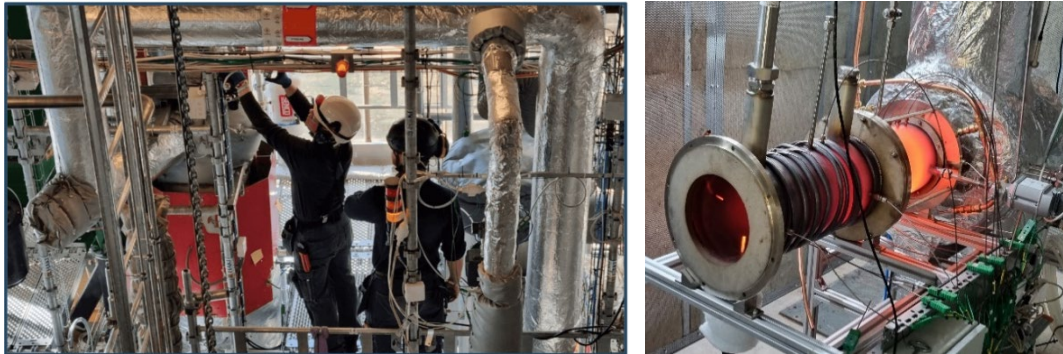
Figur 15: Förgasningssystem (vänster) och brännkammare (höger) i den integrerade testriggen, Scarlett, i Stockholm.
