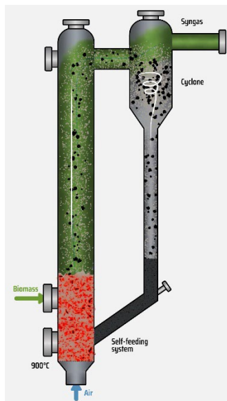
Figur 6: Skiss över HFB förgasaren. För produktion av industrigas används syre i stället för luft, då man vill minimera mängden kvävgas i processen.
